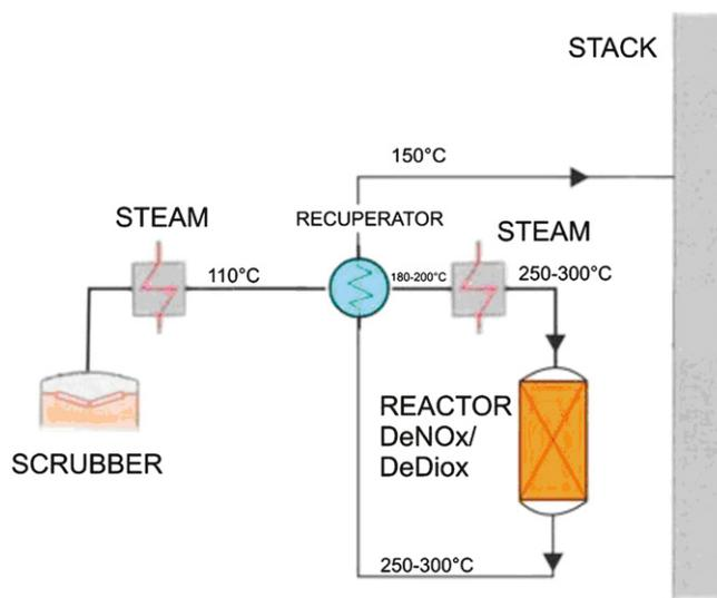
Fig. 1. Scheme of deNO<sub>x</sub>/deDiox technology (Pařízek et al., 2008).
